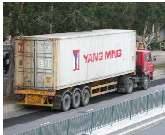
圖38 (c) 貨櫃車上的貨櫃是方箱結構的一個例子
