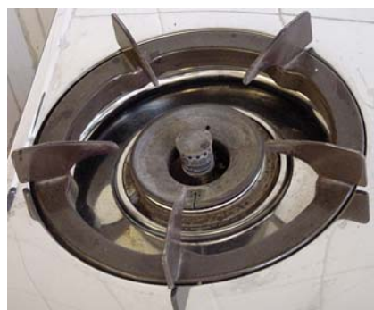
(b) 煤氣爐燃氣環
