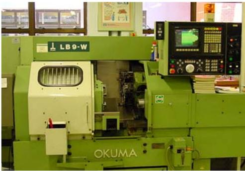
圖5 (a) 自動換刀 CNC 車床
